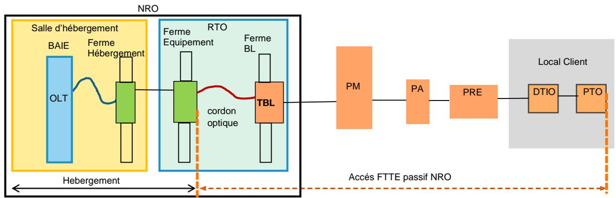
**Figure 3 : FTTE passif NRO - Raccordement au NRO avec salle d'hébergement séparée de la salle RTO**
