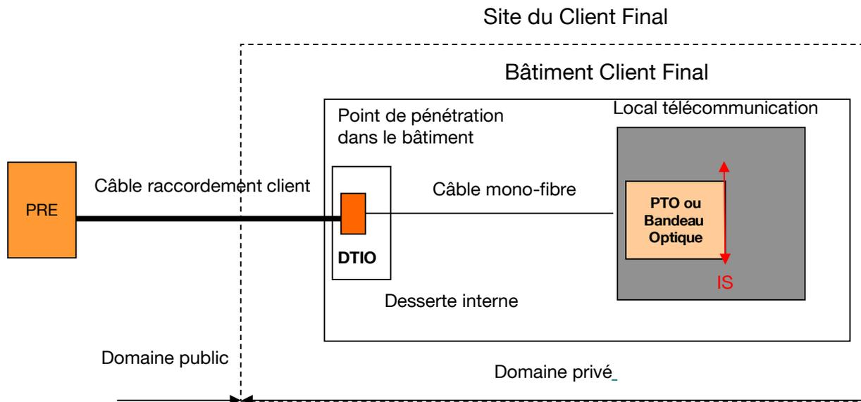
Figure 5 : FTTE passif NRO - raccordement sur PRE extérieur
