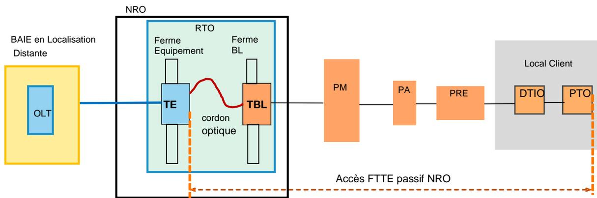
**Figure 4 : FTTE passif NRO - Raccordement au NRO avec une localisation distante**
